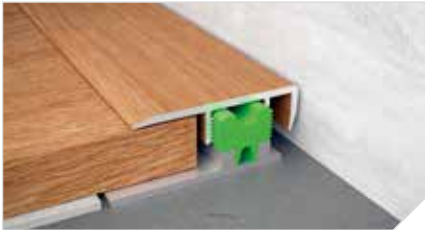
KIT PROFILO PERIMETRALE + BASE ALLUMINIO ANTIURTO per pavimenti con spess. da 7 a 8 mm rivestito con film digitale deco coordinato
