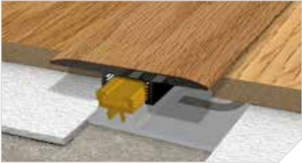
KIT GIUNTO DI DILATAZIONE + BASE ALLUMINIO ANTIURTO per pavimenti con spess. da 7 a 8 mm rivestito con film digitale deco coordinato
